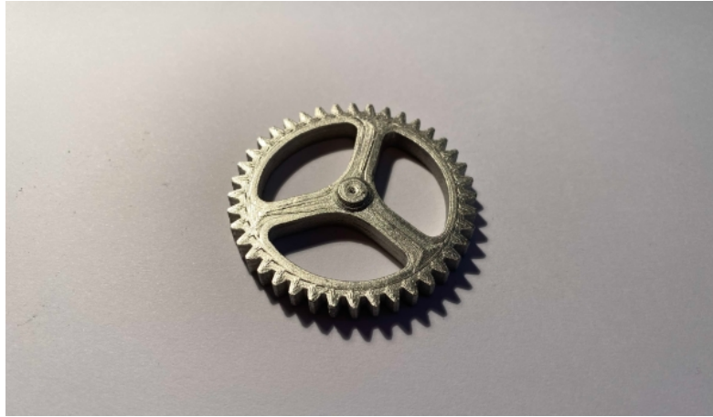
Pignon en acier inoxydable 17-4 PH imprimée sur une imprimante 3D PAM à l'état fritté.
