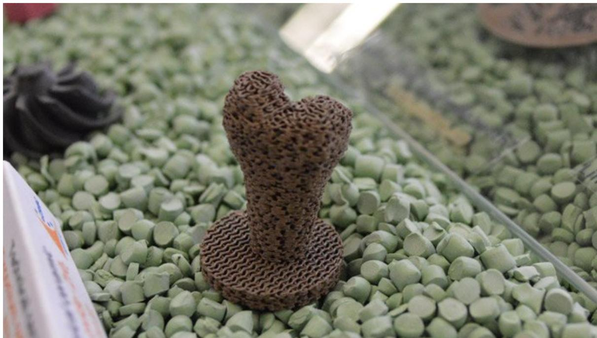
*Exemple de pièce imprimée en 3D en zircone par le CRIBC sur la machine Pollen AM (crédits photo : 3Dnatives)*
