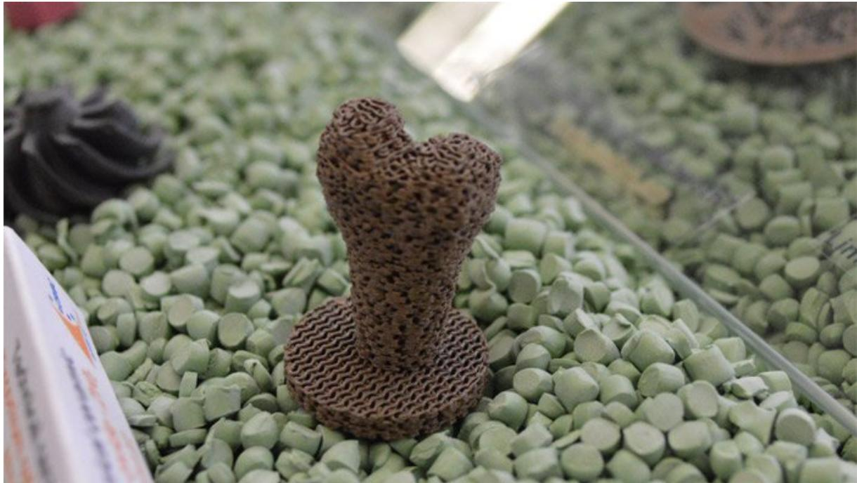
***Beispiel eines 3D-gedruckten Teils aus Zirkoniumdioxid, das vom CRIBC durch die Pollen AM Maschine gedruckt wurde (Bild: 3Dnatives)***
